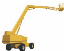
Hubarbeitsbühnen Bühnen-, Korb- und Auslegerdrehung
