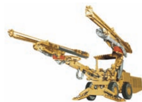
Bergbaumaschinen Karusselldrehung, Bohrmeißelpositionierung, Gestängebeförderung, Spritzbeton, Ankerabau
